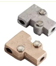
Conector en T en cobre de alta conductividad para unir cables al anillo perimetral de protección contra rayos con fijación segura y resistente a la corrosión.
