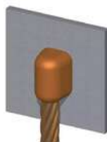
CABLE TERMINAL ASCENDENTE A SUPERFICIE VERTICAL
